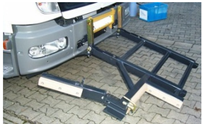
Abbildung 3 – HS54-AT-119 doppelt abgeklappte Stütze
